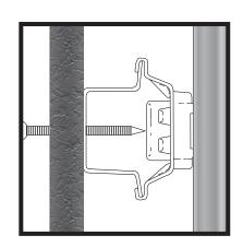
NOTA Es imposible que ocurra un "corto circuito" en el sistema **GenieClip RST** cuando se utilizan los tornillos adecuados. Si el instalador hiciera contacto con la ubicación de un clip, no podría "colocar" el tornillo. Se vería obligado a moverse a la izquierda o a la derecha de la ubicación del **GenieClip RST**.
